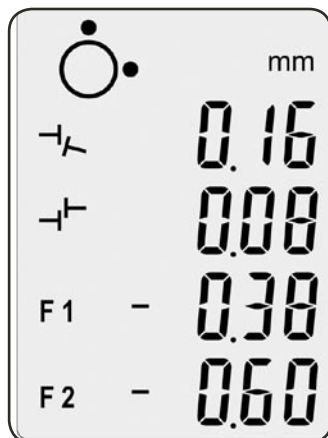
Fig. 19. Défaut d'alignement mesuré
