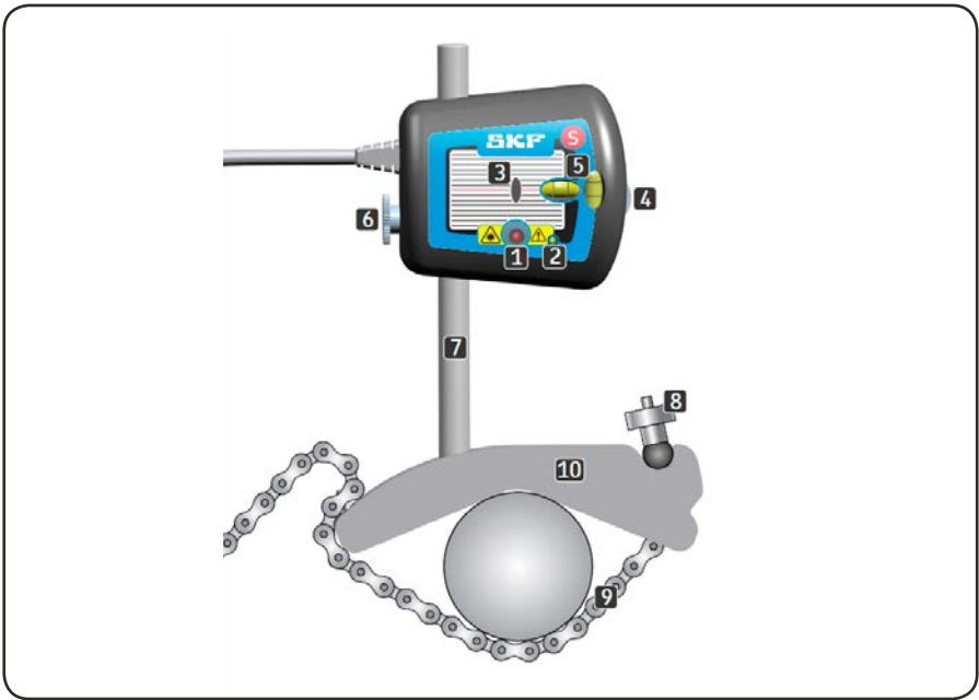
图7. 固定支架和测量单元
