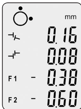
Kuva 21. Pystysuunnassa tapahtuvan linjauksen näyttö
