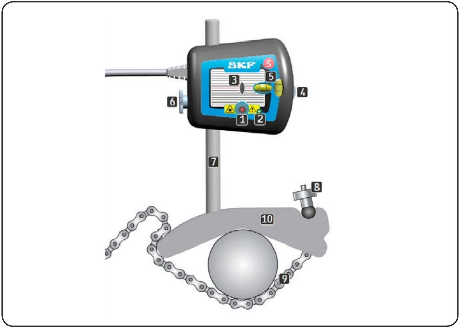
Fig. 7. Fixation mécanique avec appareil de mesure
