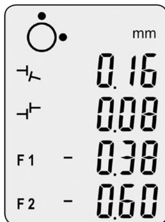
Afb. 21. Verticale uitlijning weergegeven
