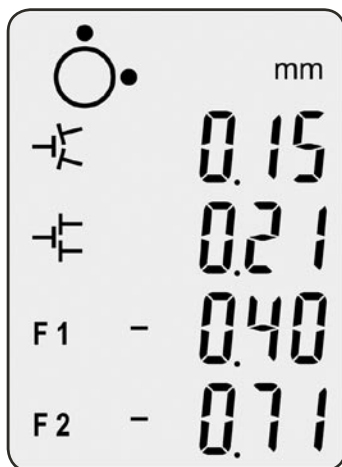
Fig. 25. Affichage de l'alignement horizontal
