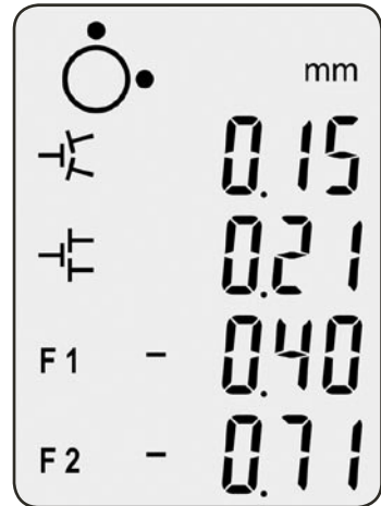
Afb.. 25. Horizontale uitlijning weergegeven
