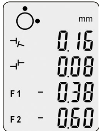
Fig. 21. Affichage de l'alignement vertical
