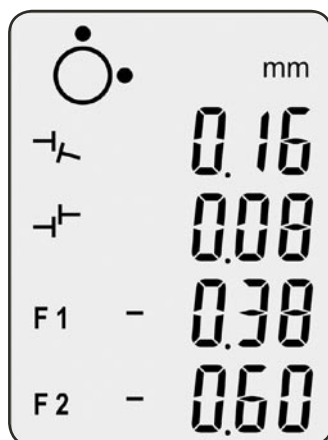
Fig. 21. Indicação do alinhamento vertical
