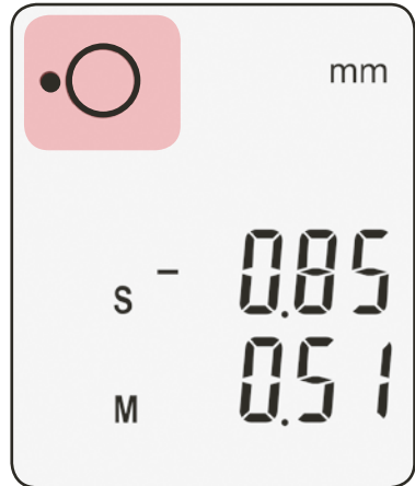
Afb. 16. Display toont dat de 9-uur-positie de vereiste is
