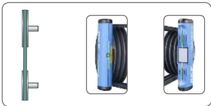
Figure 9 Poulies parfaitement alignées
