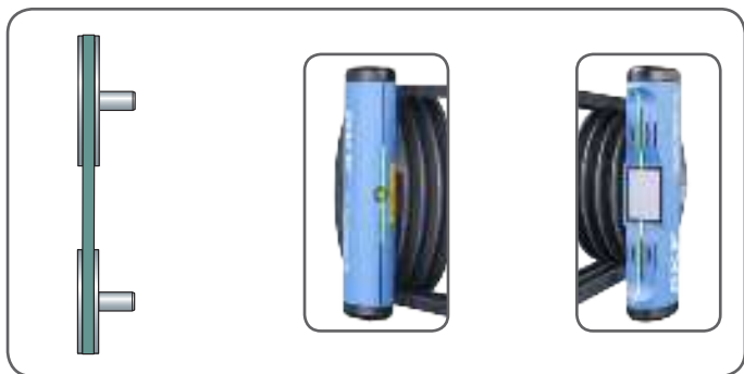
图 9 皮带轮已完美对中
