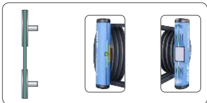
Figura 9 Polias perfeitamente alinhadas
