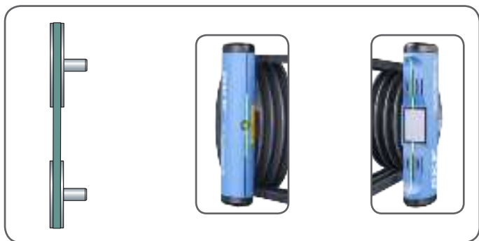
Figure 9 Pulegge perfettamente allineate
