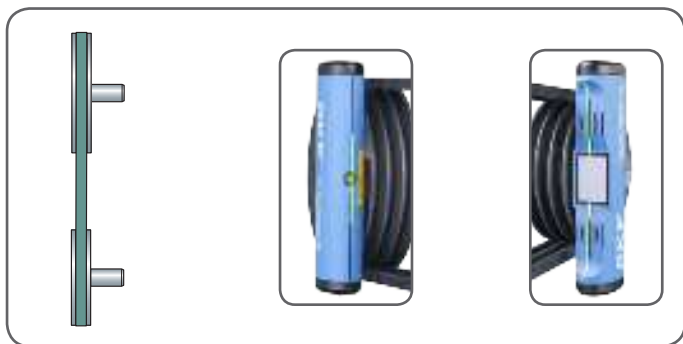
Рисунок 9 Соосность шкивов после правильно выполненной выверки
