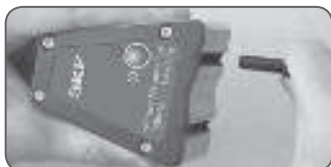
Fig 2 Ajustement ou retrait des guides V
