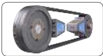
图4 激光单元装到皮带轮槽的示意图
